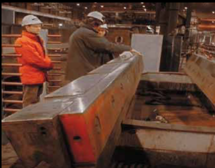
Toolox 44 Schermesser nitriert -8000 Schnitte bis 35 mm 960 MPa
