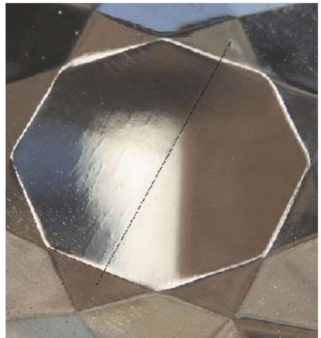
Rechte Hälfte wurde nach reklamierter „Orangenhaut“ nach poliert.
